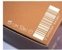
Code-barres imprimé au laser sur carton
