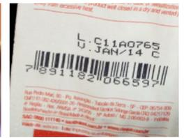
Code-barres imprimé par jet d'encre continu sur un emballage sous blister
